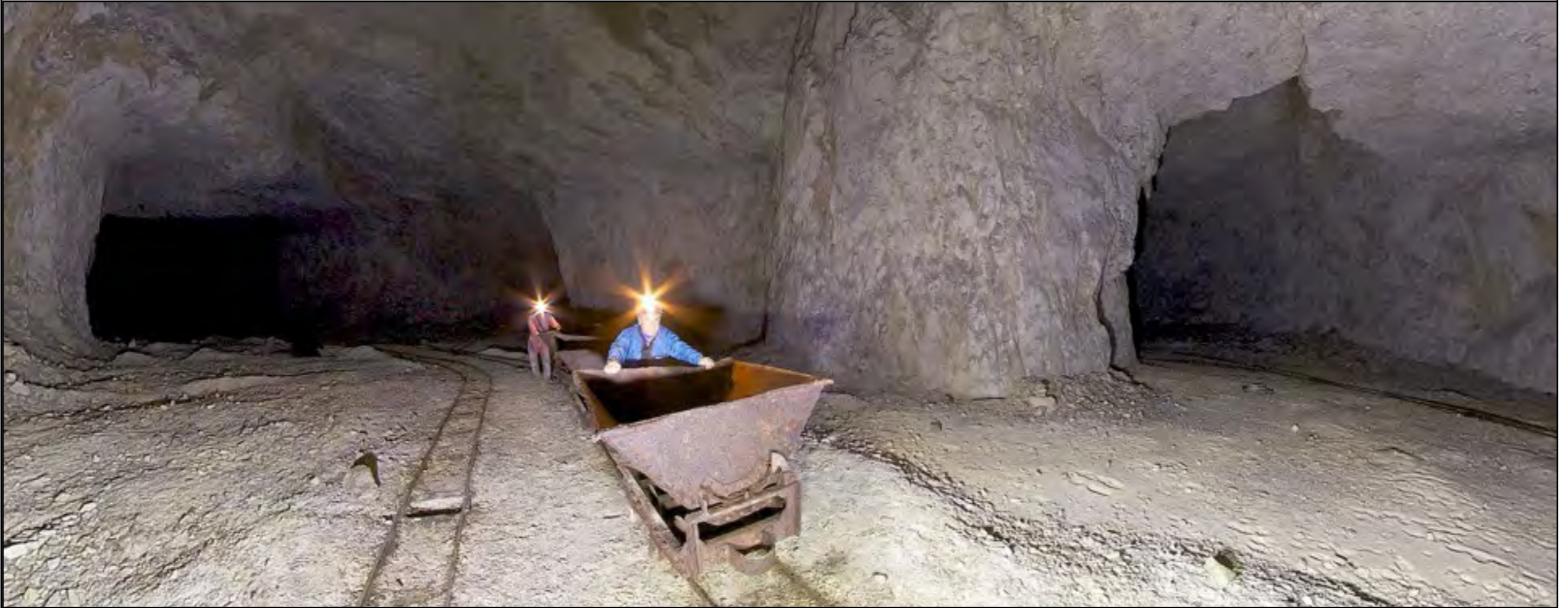
Voies étroites et wagonnets basculeurs, in situ.
